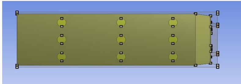
Fig: 1 liner holes
